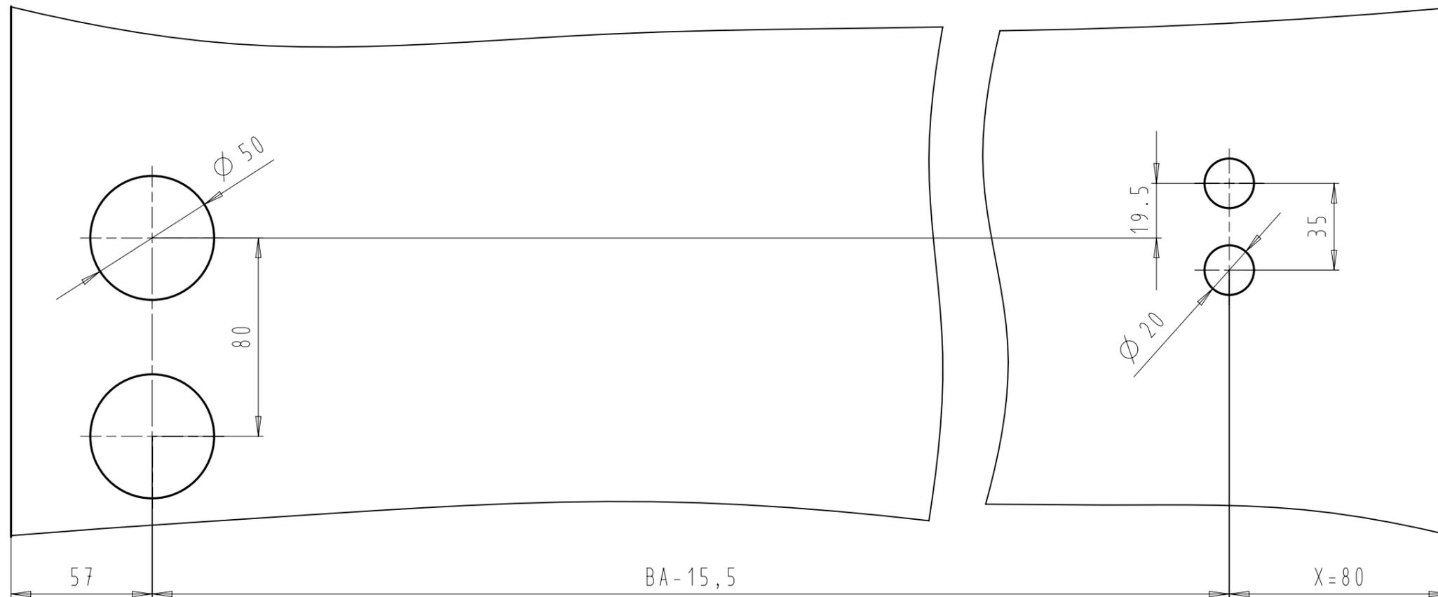
BA=Befestigungsachse der Druckstange
